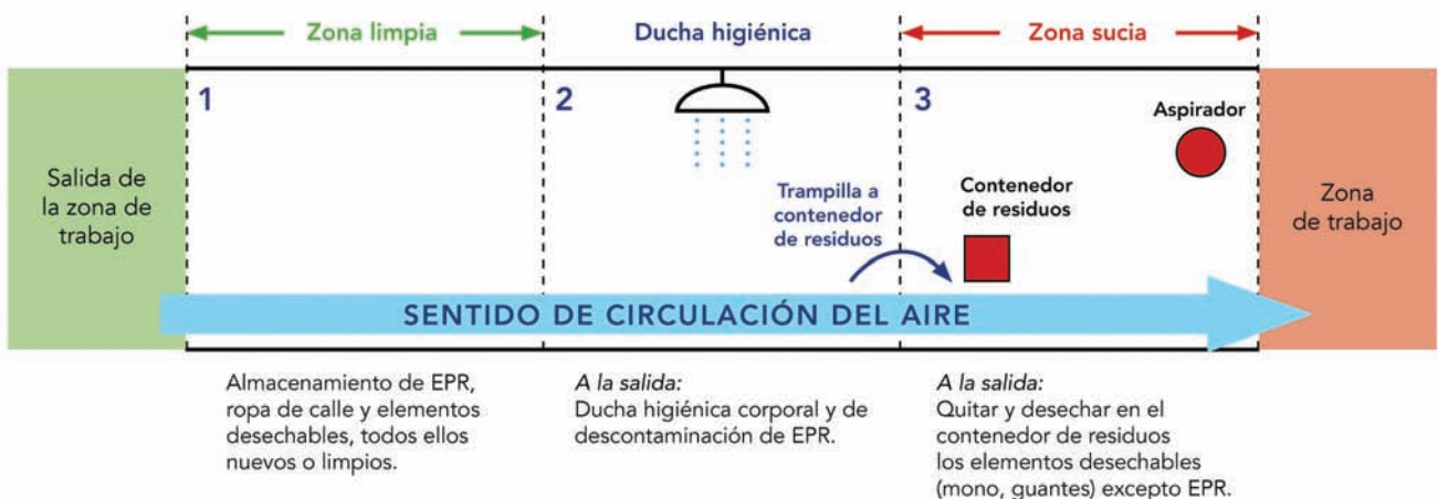
Figura 1. Esquema de una posible disposición de la unidad de descontaminación con tres módulos.
