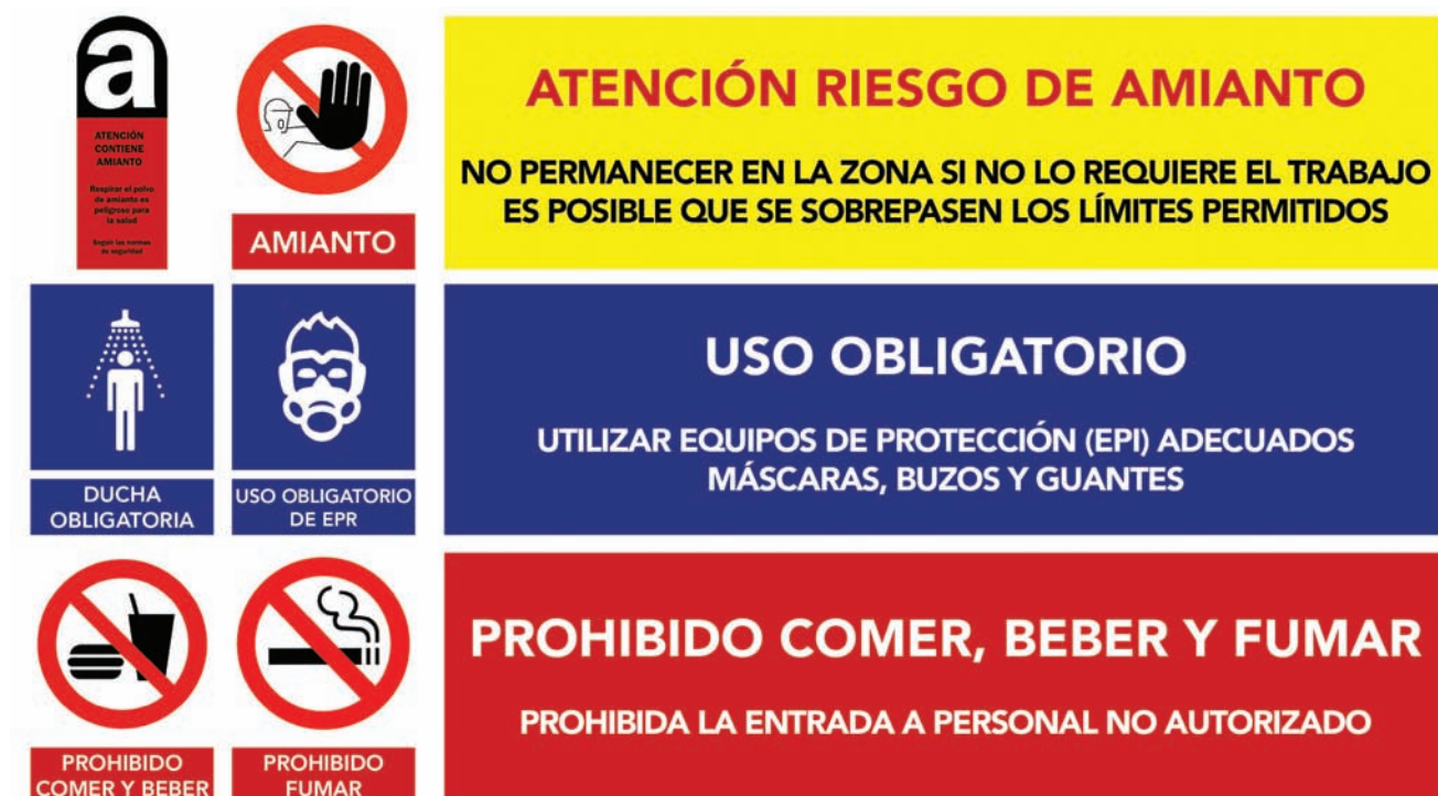
Figura 5. Posible panel de advertencia de riesgo de amianto
