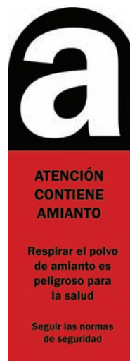
Figura 2. Etiqueta reglamentaria de identificación de materiales con amianto.
