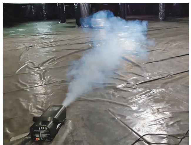
Figura 9. (a) Control de la eficacia del confinamiento mediante prueba de humos.
