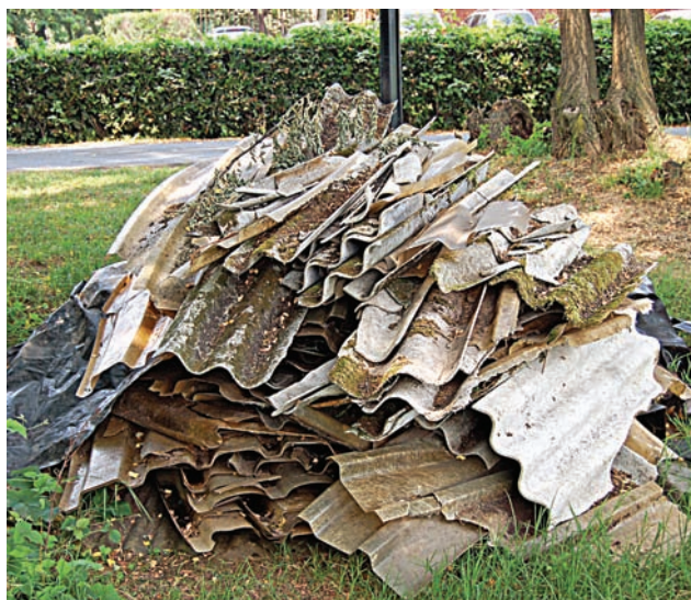
Figura 17. (a) Residuos incontrolados de fibrocemento.
